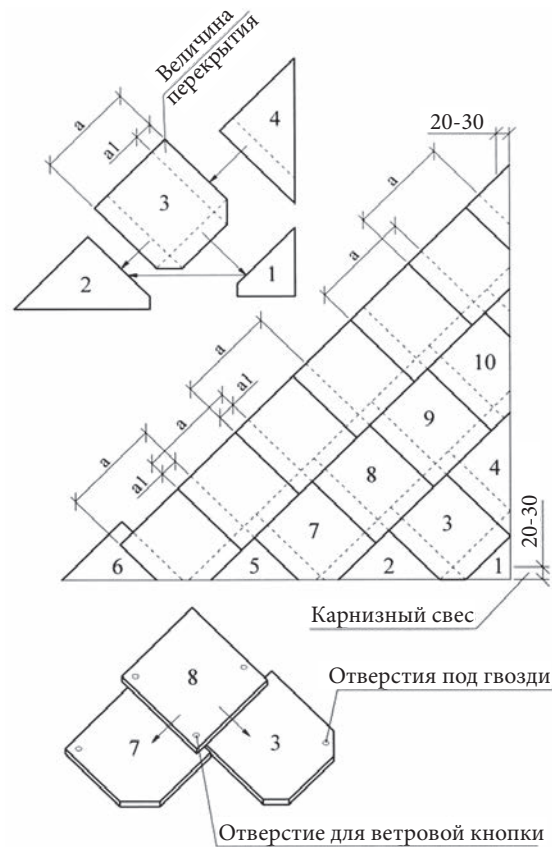
Рисунок 9.6. Диагональный метод укладки хризотилцементных плиток
