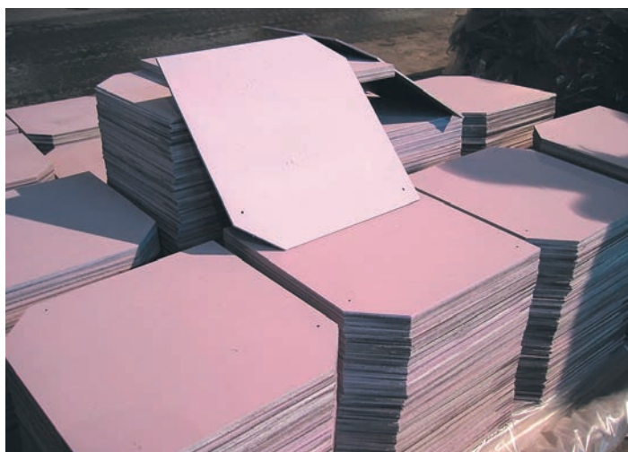
Рисунок 5.1. Мелкоразмерные хризотилцементные плитки
